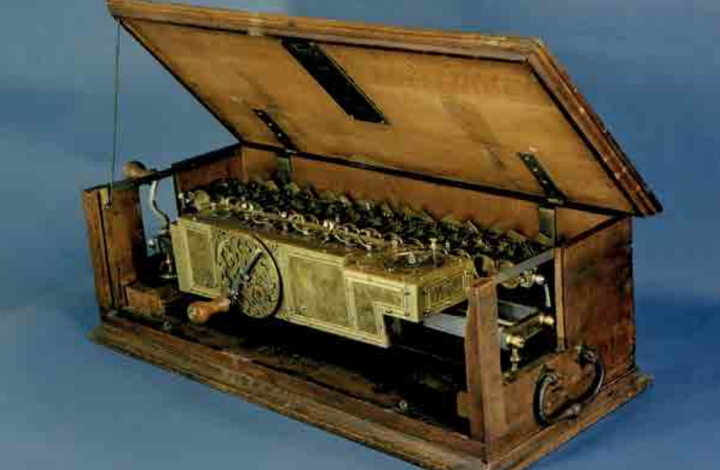
Einzig erhaltenes Original einer der großen Leibnizschen Vier-Spezies-Rechenmaschinen mit Staffelwalzen
